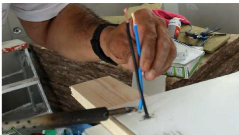
Après le soudage, nous procédons à la pose de la plaque. La plaque doit être placée très soigneusement, de manière à ce qu'elle soit collée dans le périmètre établi, en commençant à coller à une extrémité de la plaque.
